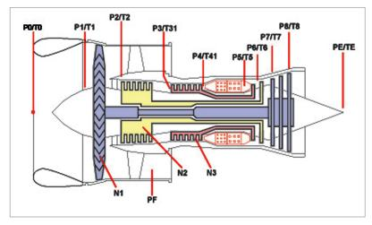
Figure 13.11 Triple spool front fan turbojet
